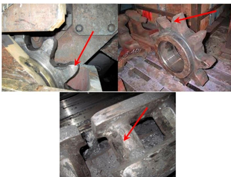
Сурет 9 – Eicotrack тасымалдау жүйесінде қолданылатын редукторлардың тозу түрі, тіректің шеткі түйреуіштерінің бірі
